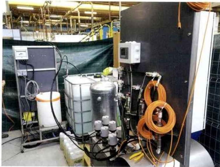
Unité d'injection de mousse bloquante. Serpol avec Renault, l'ENSEGID et l'ADEME a utilisé une mousse biodégradable comme agent de confinement temporaire in situ d'un sol contaminé par des solvants chlorés. Objectif: stopper ou réduire les écoulements d'eau souterraine et contribuer à améliorer l'efficacité des traitements.
