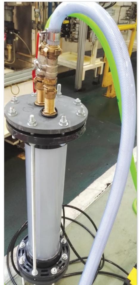
Mousseur : de l'eau additionné de tensio-actif ainsi que de l'air sous pression sont injectés simultanément pour former la mousse de blocage.
